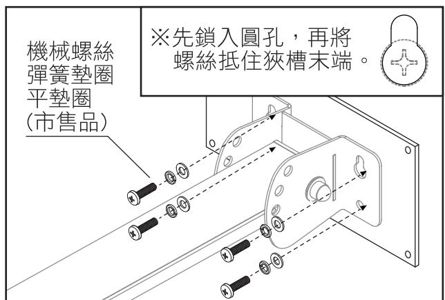
3. 先於風機端裝上螺絲、U型螺帽與平墊圈，並預鎖螺絲約7mm的間距
