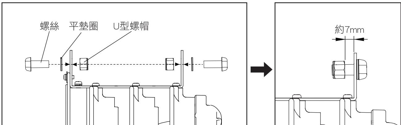
4. 確認風機端的螺絲等零件安裝後將風機懸掛於懸臂連接架上，完成後請將兩側螺絲鎖緊
