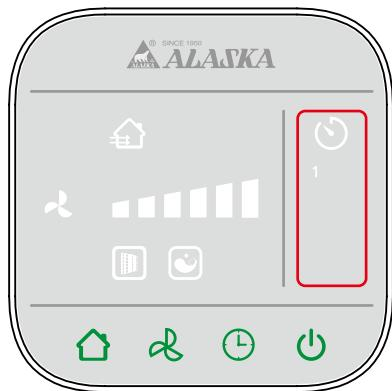
畫面中紅色方框處顯示定時關機的剩餘時間，時間結束後立即關機，回到待機狀態。
