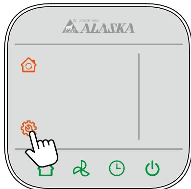
切換模式時若發生異常“
