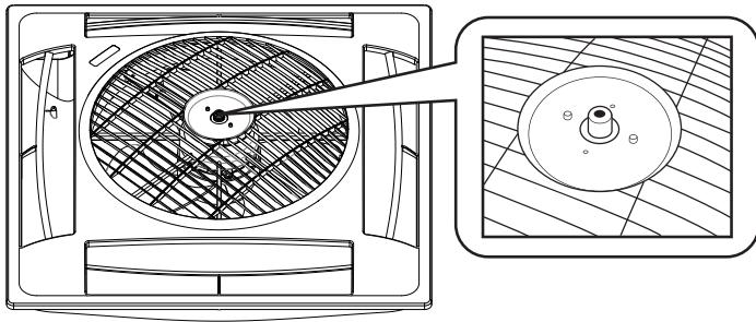
**2** 轉盤固定座鎖至接觸導風轉盤即可，不需過度緊鎖完成以上步驟後方可將循環扇安裝於輕鋼架上。
