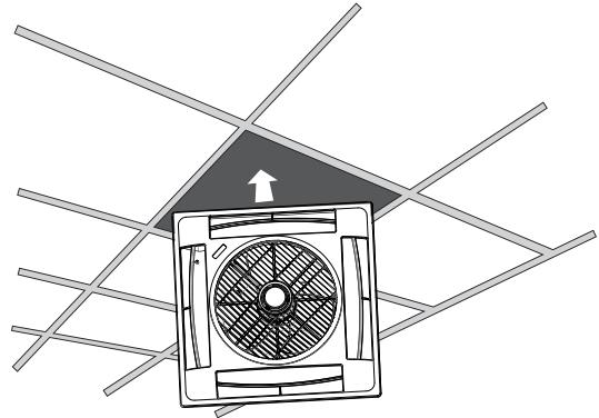
**5** 將安裝循環扇另一邊的天花板打開將電源線插入快速接頭內。(確認電壓為110V或220V)
